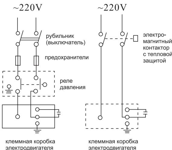
1. Электрические соединения и защита должны быть проведены согласно норм и правил установки электрооборудования. Спецификация рабочего напряжения отмечена на табличке с изделием. Обеспечьте соответствие электрических параметров электродвигателя с параметрами электрической сети.
