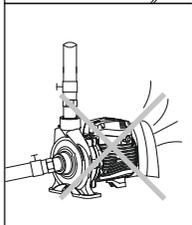
5. Насос повинен знаходитися у вентилязованому приміщенні, конструкція якого повинна запобігати проникненню атмосферних опадів на корпус і всередину електродвигуна.
