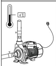
6. У разі падіння температури докільля нижче 4 °С, або у разі тривалого простою насоса, порожня гідросистема може бути пошкоджена. Не використовуйте насос при тривалій відсутності води.
