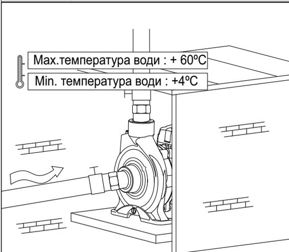
1. Для монтажу насоса вхідна труба має бути настільки короткою наскільки можливо з найменшою кількістю вигинів. Насос має бути встановлений у вентиляваному і сухому місці. Насос може бути встановлений на вулиці з умовою забезпечення належного перекриття для запобігання негативному впливу погодних умов.
