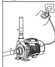
9. Следите, чтобы насос неожиданно не включился при монтаже или демонтаже, в этом случае и при длительном простое всегда держите сетевой тумблер выключенным, а входной и выходной клапаны закрытыми.
