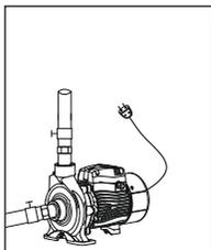
2. Електричний насос повинен мати надійне заземлення для запобігання ураженню електричним струмом. Для безпеки насос рекомендовано оснастити пристроєм захисного відключення (ПЗВ). Не мочити штепсель мережевого шнура.
