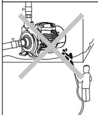
4. Уникайте розбризкування води під тиском в електричний насос, а також не допускайте занурення (навіть часткового) електронасоса у воду.
