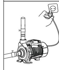
9. Стежте, щоб насос несподівано не включився при монтажі або демонтажі, в цьому випадку і при тривалому простої завжди тримайте мережевий тумблер вимкненим, а вхідний і вихідний клапани закритими.
