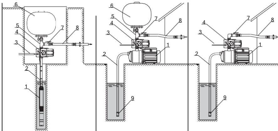
Мал 1. Установка з заглибним насосом
