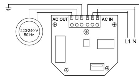
Для однофазного насоса сила струму не може бути більше, ніж 10 А, а максимальна потужність електродвигуна не повинна перевищувати 1,1 кВт. Переконайтеся в правильності підключення електричної схеми (див. Електричну схему). Рекомендуємо установку диференціального вимикача (УЗО) з струмом відключення рівним 30 mA. Підвідний кабель повинен відповідати стандартам ЄЕС.
