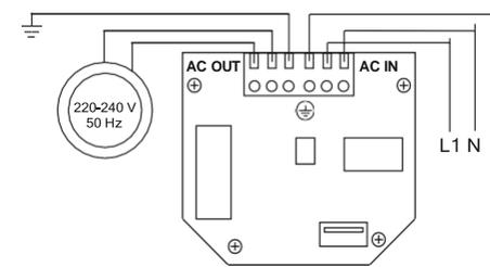
Для однофазного насоса сила тока не может быть больше, чем 10 А, а максимальная мощность электродвигателя не должна превышать 1,1 кВт. Убедитесь в правильности подключения электрической схемы (см. электрическую схему). Рекомендуем установку дифференциального выключателя (УЗО) с током отключения равным 30 мА. Подводящий кабель должен соответствовать стандартам ЕЭС.
